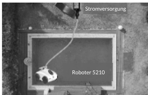
4.1 Platzieren Sie den Transformator mittig und in einem Abstand von mindestens 3,50m zwischen den beiden Enden des Pools.
