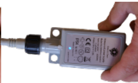
4.5 Um den Roboter auszuschalten, ziehen Sie den Stecker. Der Reiniger stoppt automatisch nach 1 Stunde Benutzung. Um einen neuen 1H Reinigungszyklus zu starten: - Den Stecker des Transformators ziehen - 2 oder 3 Minuten warten - Den Transformator erneut anschließen
