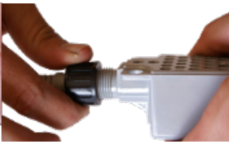
4.4 Schrauben Sie die Mutter des Schwimmkabels fest. Dann schließen Sie den Transformator an. Ein blaues Licht, das die Aktivierung des Roboters anzeigt, erscheint.
